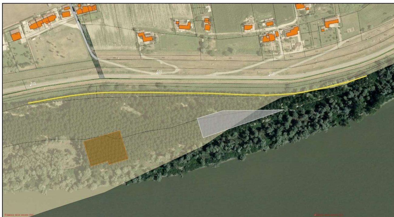
Figura 6 - Area di posizionamento temporaneo del materiale di risulta dello scavo del diaframma (linea gialla) su base catastale, il poligono marrone individua l'area di prelievo della terra golenale (1° stralcio), il poligono grigio l'area di deposito temporaneo del pietrame.
