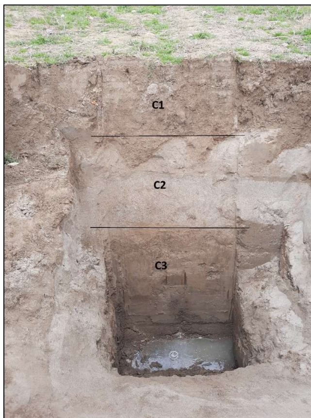
Figura 10 - Profilo verticale Sc1 nell'area di prelievo golenale (ubicazione in Fig. 12).
