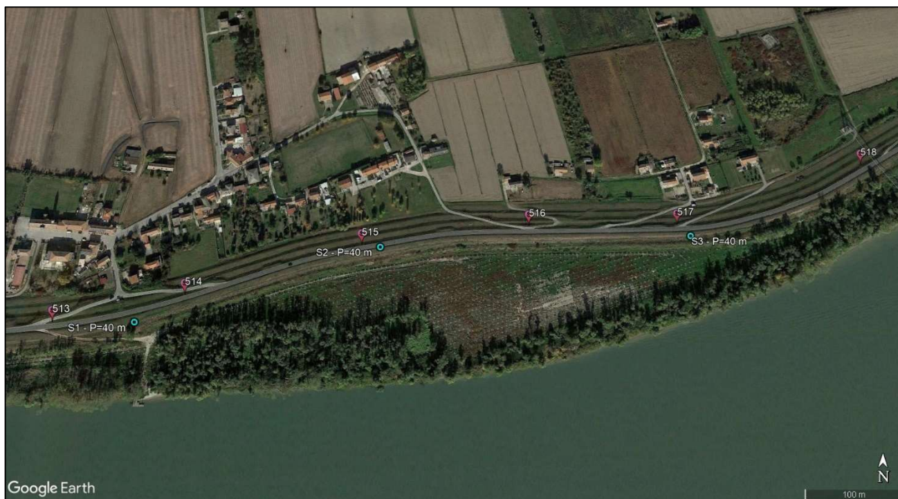
Figura 11 - Localizzazione carotaggi (con indicazione degli stanti) in sommità arginale eseguiti ai fini della caratterizzazione ambientale ai sensi della normativa “terre e rocce da scavo” - loc.tà Mazzorno Sinistro – Adria (RO).
